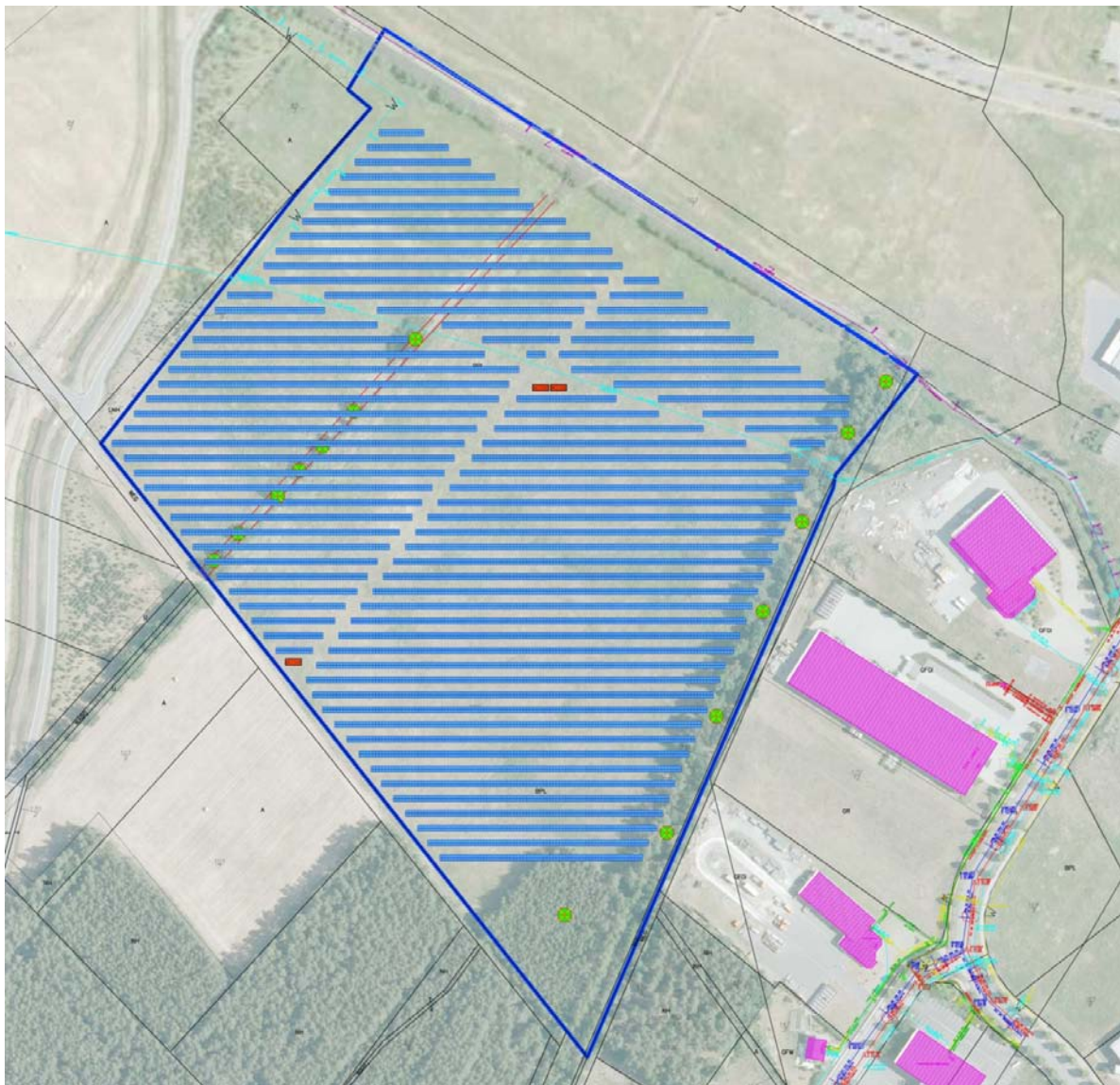
Abb. 3 Unverbindliche Technische Vorplanung - Modulbelegungsplan
