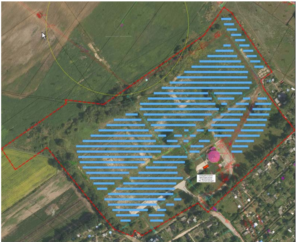
Abb. 3 Unverbindliche Technische Vorplanung - Modulbelegungsplan
